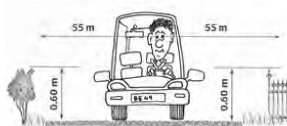
Sichtfeld bei Strasseneinmündungen.
